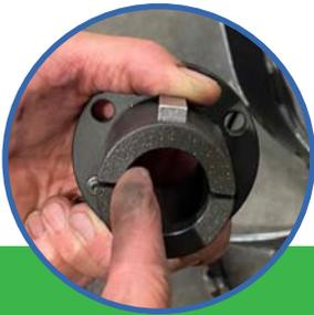
1. S'assurer que les surfaces coniques de la douille et l'intérieur de l'hélice sont propres
