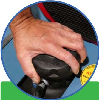
1. Ouvrir le capot du réservoir de carburant
