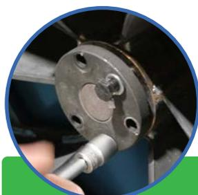
4. Serrer progressivement les vis à tête dans le sens des aiguilles d'une montre en appliquant un couple égal jusqu'à ce que la bague se désengage
