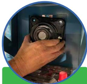
2. Installer la cale de roulement et le roulement dans l'arbre d'entraînement
