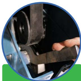
6. Tendre la courroie à l'aide d'un crochet
