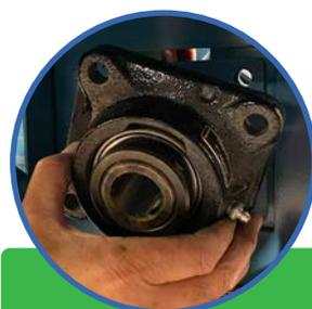
3. Retirer le roulement et éliminer les bavures métalliques de l'arbre avec une lime si nécessaire
