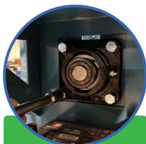
1. Retirer les 4 boulons de la bride du roulement
