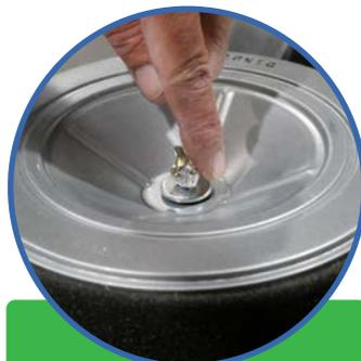
2. Retirer l'écrou à ailettes pour libérer le filtre à air
