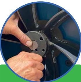
4. Engager les vis d'assemblage à la main en les tournant juste assez pour engager les filets
