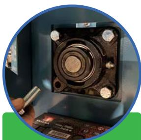
2. Desserrer les 2 vis de réglage du moyeu du roulement
