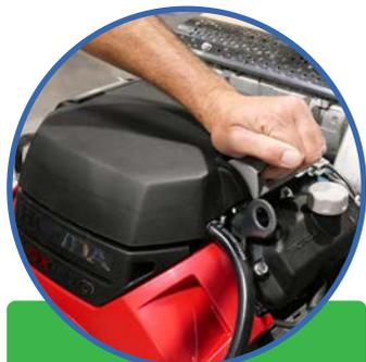
1. Retirer le capot supérieur pour accéder au filtre à air
