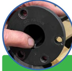
5. Avec la clavette dans la rainure de l'arbre, faites glisser l'hélice et la douille sur l'arbre du moteur
