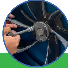
6. Serrer progressivement les vis d'assemblage à l'aide d'une clé dans un sens circulaire pour assurer une tension égale lorsque l'hélice descend sur l'arbre, afin d'obtenir un couple de 22 Nm
