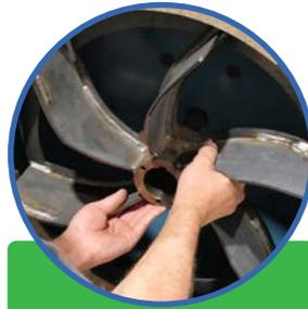
3. Placer la douille sans la serrer dans le moyeu de l'hélice
