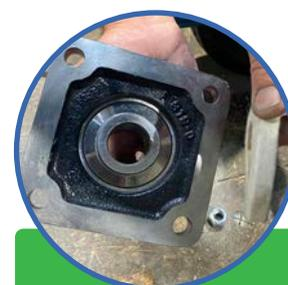
4. Installer de nouveaux roulements avec des joints en feutre
