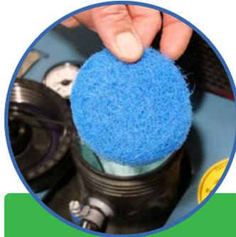
2. Vérifier que le réservoir de carburant et le filtre ne contiennent pas de débris
