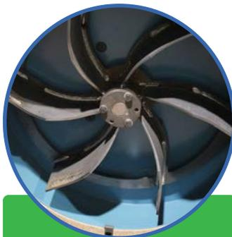
7. Nettoyer la chambre du ventilateur et éliminer l'accumulation d'isolant sur le ventilateur
