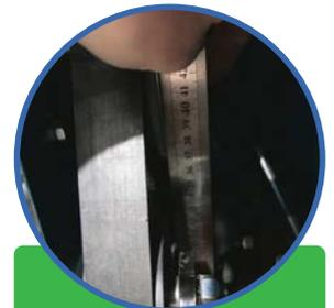
4. Aligner toutes les poulies sur un même côté et serrer les 4 boulons de roulement
