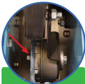
2. Desserrer le boulon 1/2" sur la poulie pour relâcher la pression de la courroie
