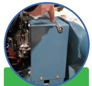
8. Installer les protections de courroie et les fixer avec les boulons
