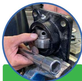
5. Utiliser un frein filet démontable sur les vis de réglage avant de fixer le roulement à l'arbre
