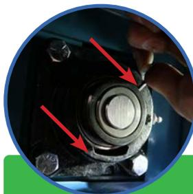
3. Desserrer les 2 vis de réglage du palier arrière
