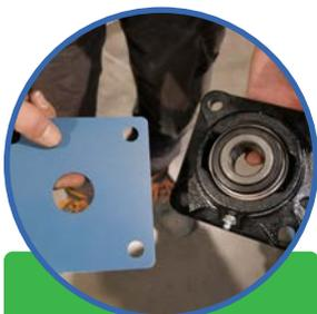
5. Déposer le roulement arrière et la cale de roulement
