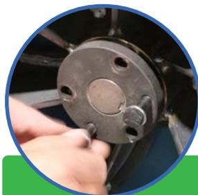
3. Les insérer dans les trous taraudés de la bride de la douille
