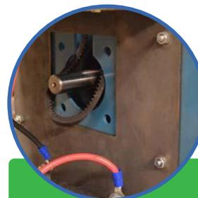
7. Tirer le haut de la courroie vers la chambre et le bas de la courroie par l'ouverture du dessous
