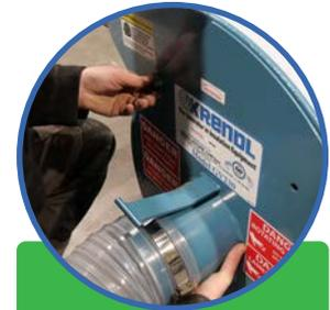
7. Installer le couvercle de la chambre du ventilateur et le fixer avec des boulons
