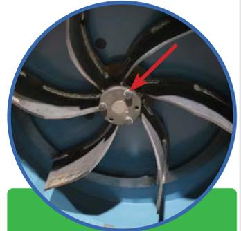
4. Vérifier le couple de serrage des boulons de la douille de verrouillage conique (22 Nm)
